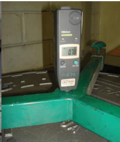
Fig.13 - Ensaio de Flecha
